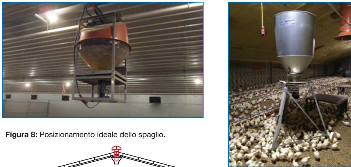
Figure 7: Esempio di spaglio fisso a coclea centrale( destra) e spaglio mobile (sinistra).
